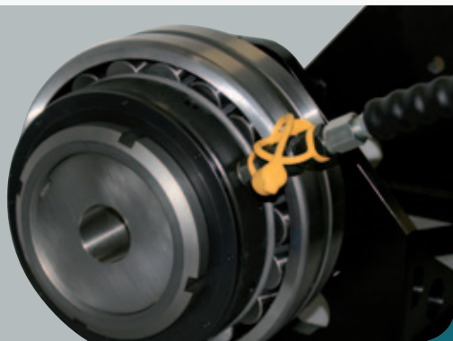
Extração da bucha de aperto pela porca hidráulica
