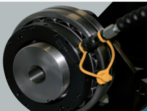
Extração da bucha de desmontagem pela porca hidráulica (montagem inversa da precedente)
